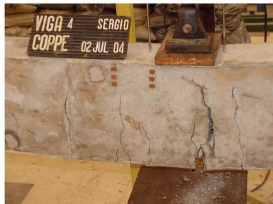
**Figura 16 (b)** – Viga V2 após o ensaio (OLIVEIRA, 2005).
