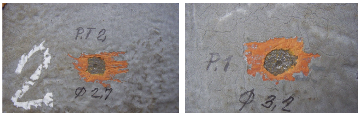
Figura 4 – Medições de dureza nos principais elementos da estrutura.
