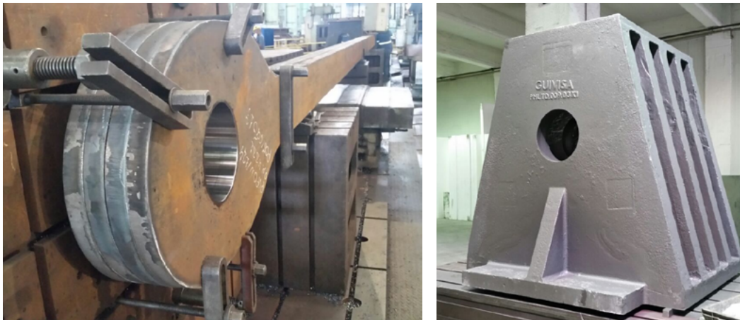
Figura 13 – Fabricação das barras de olhais e selas.
